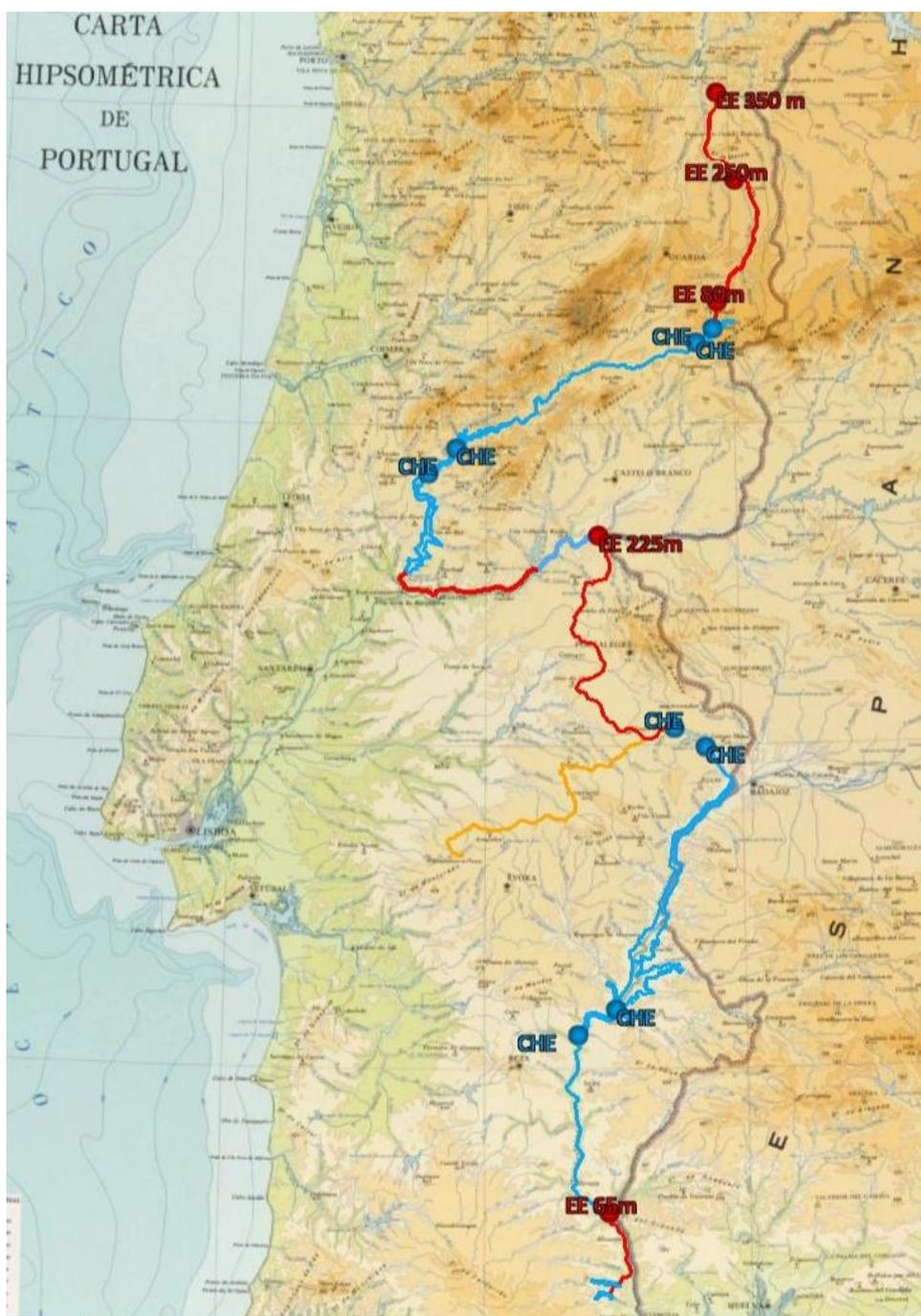
Na barragem do Sabugal já existe o Túnel Sabugal – Meimôa, que liga as bacias do Côa (Douro) e Zêzere (Tejo), esgotando para a barragem da Meimôa, construída na ribeira do mesmo nome, afluente da margem esquerda do rio Zêzere. Esta obra terá de ser ampliada, para receber caudais superiores aos agora possíveis.
